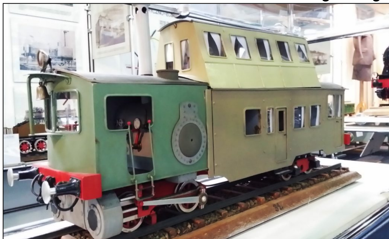
Parowy wagon osobowy dwupiętrowy konstrukcji Kraussa z 1889 r. posiada 47 miejsc siedzących
